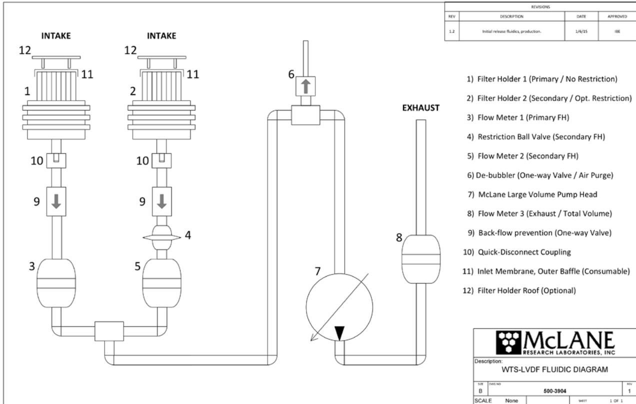
Figure C.1.1-2: WTSLV-DF Fluidic Diagram
