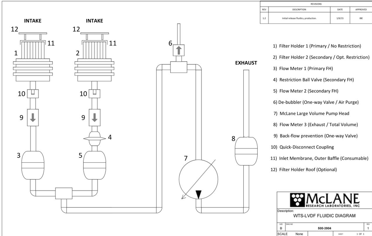
Figure C.1.1-2: WTSLV-DF Fluidic Diagram
